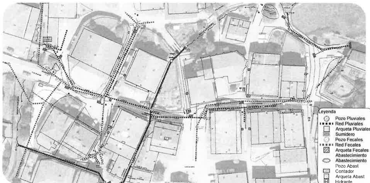
Fig. 3.2: Planta de redes existentes en la actualidad
