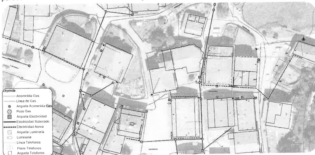
Fig.3.3: Planta de servicios existentes en la actualidad
